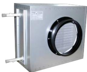
Канальные контуры нагрева/ охлаждения монтируются в канале воздуховода и имеют стандартную производительность. Контур изготовлен из медных трубок и алюминиевых пластин. Подключения для приточного и вытяжного воздуха на модуле совместимы с воздуховодами круглого сечения установки. Контур охлаждения оснащается поддоном для сбора конденсата и дополнительной изоляцией, предотвращающей его образование внутри самого модуля.
